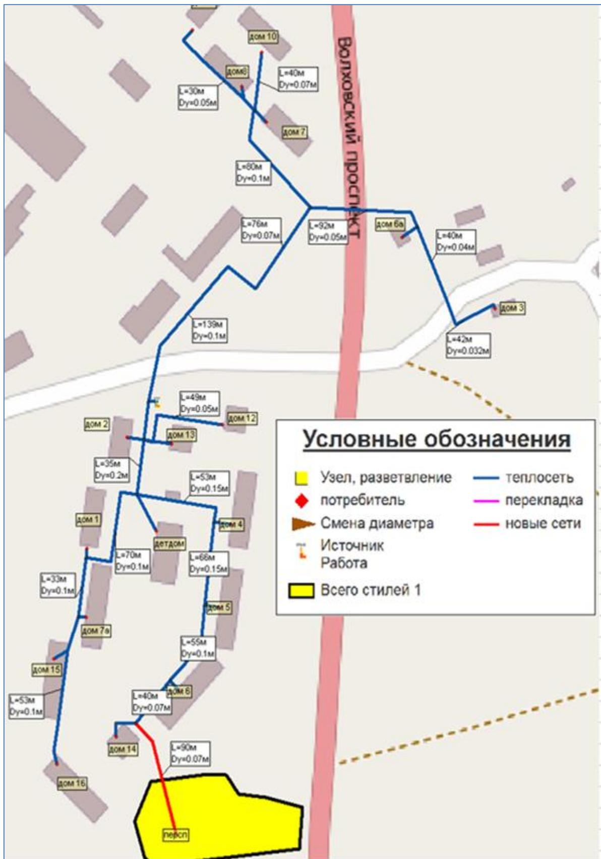
Рис. 1.6.1. Схема тепловых сетей котельной № 17 с учетом подключения участка перспективного теплоснабжения
